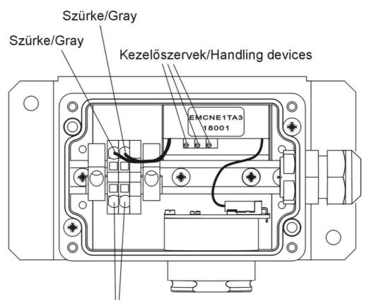
Tápfeszültség bekötési pontok Power supply connection points
